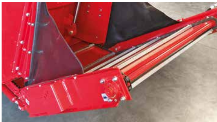
Откидной разгрузочный цепной транспортер отлично подходит для раздачи корма в высокие кормушки.
